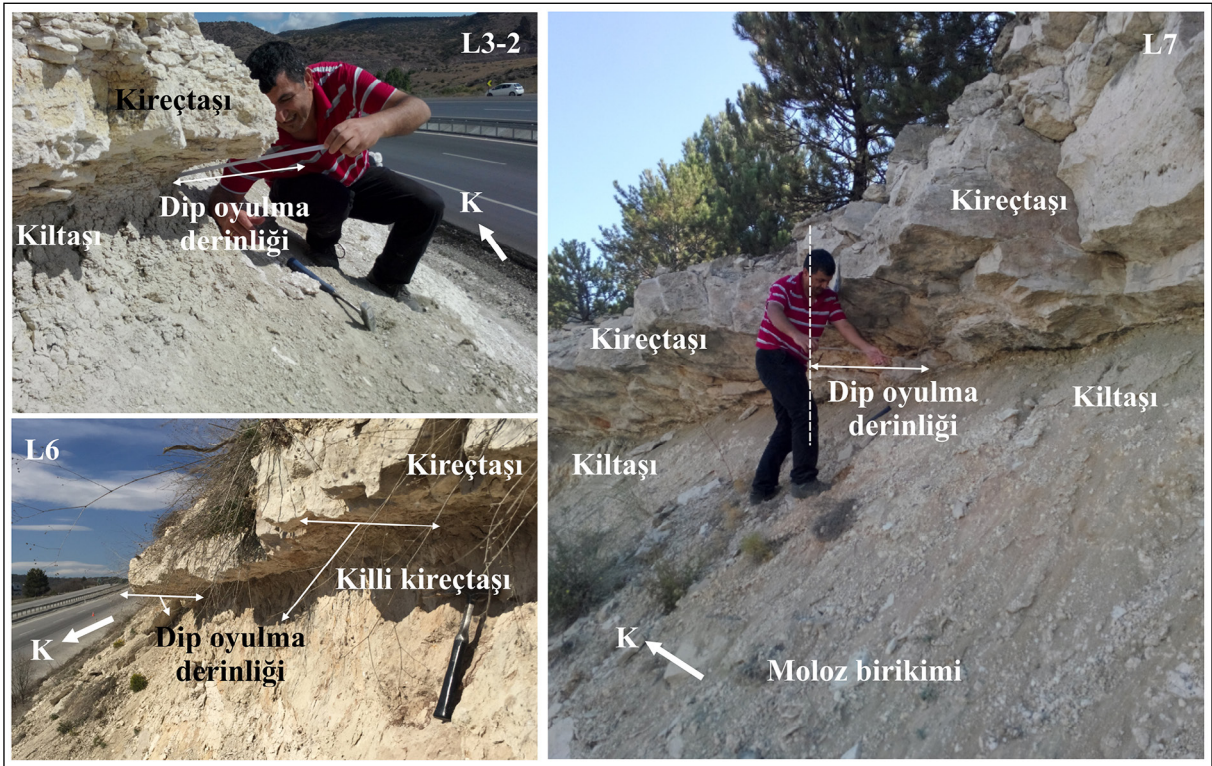
Şekil 4- Kazı tarihleri bilinen karayolu şevlerinde alınan dip oyulma derinlikleri ölçümleri.
