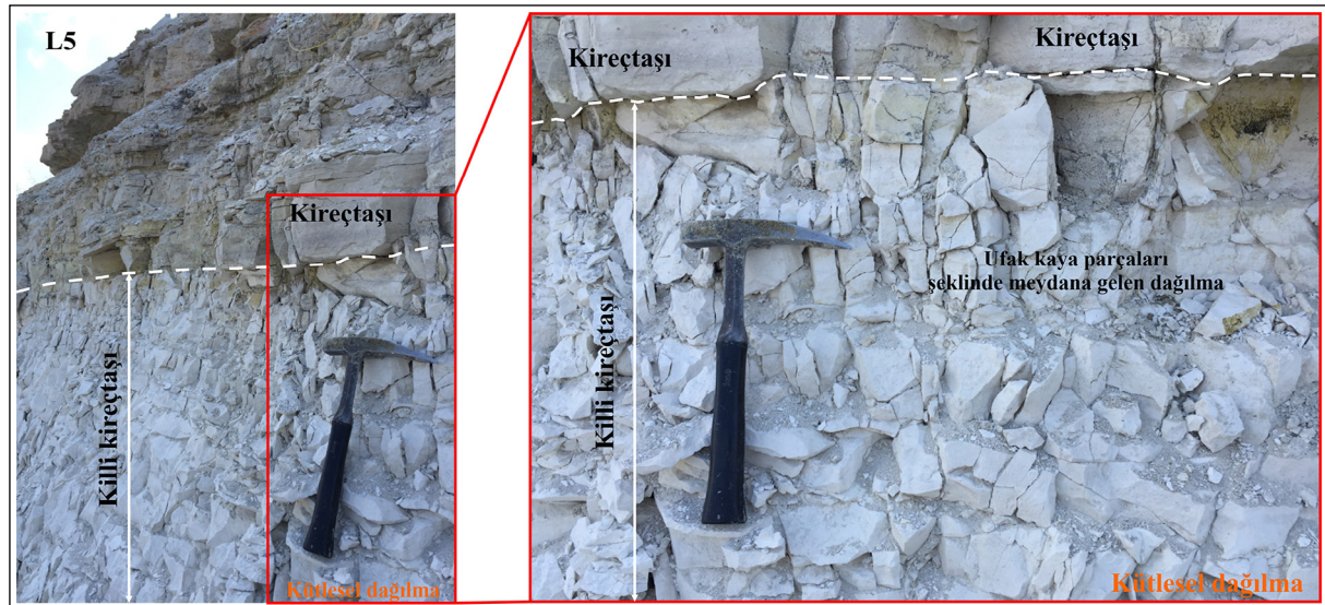
Şekil 10- Killi kireçtaşlarında atmosferik koşullarda ufak kaya parçaları şeklinde meydana gelen kütsel dağılma davranışına tipik bir örnek (L5).
