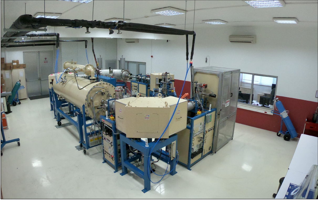
Şekil 1- TÜBİTAK AMS laboratuvarındaki AMS sistemi.
