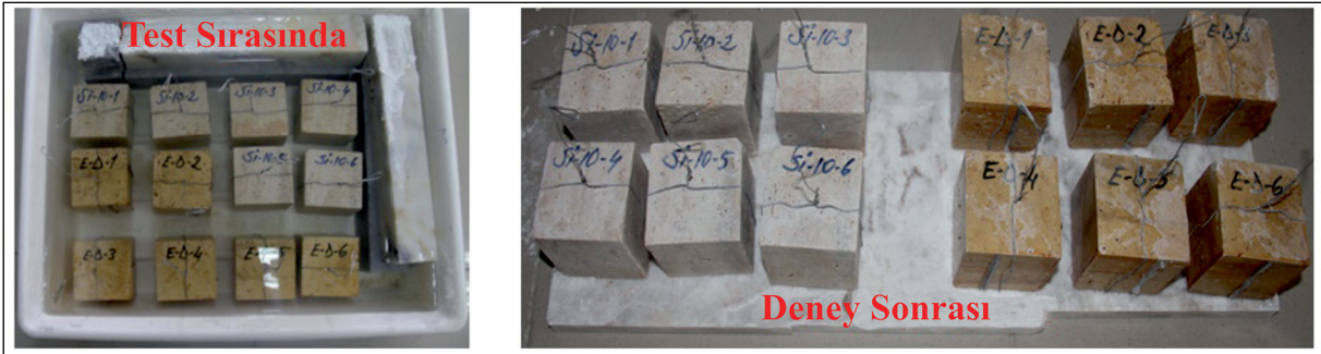
Şekil 7- Deneyler sırasında ve sonrasında epoksi ve silana batırılmış numunelerin görselleri.
