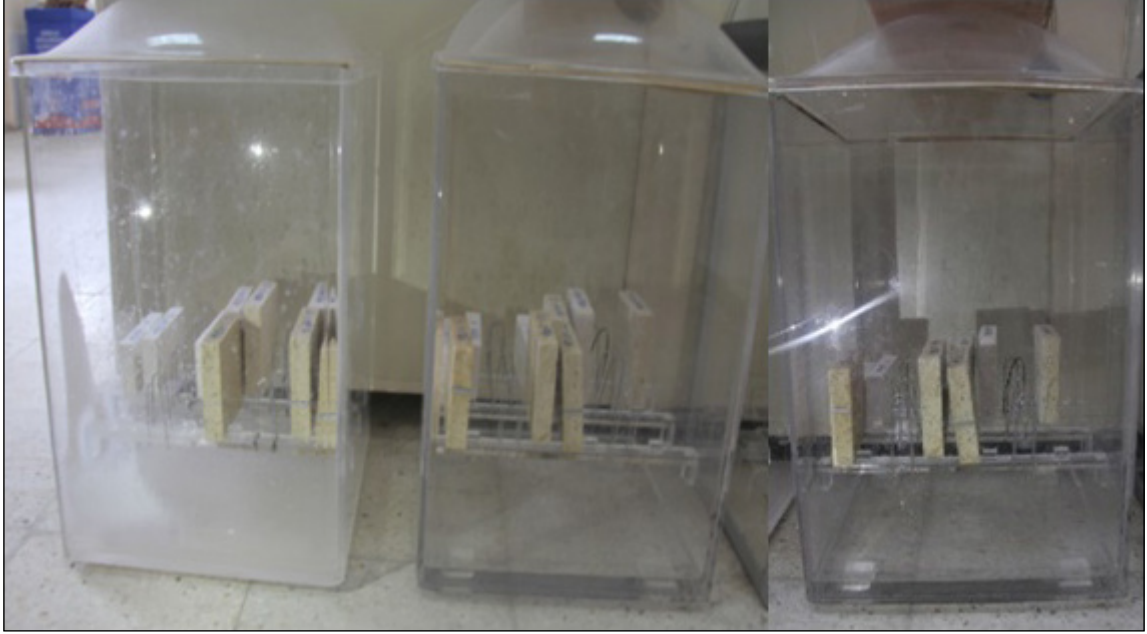
Şekil 9- Nemli bir ortamda SO 2 ile yaşlanmaya karşı direncin belirlenmesi için yapılan testten görüntü.
